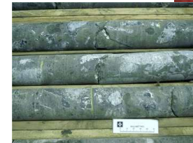
Échantillonnage par forage (ici projet ODP)
