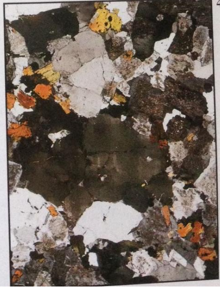
Quartz : Extinction roulante et cristaux xénomorphes
