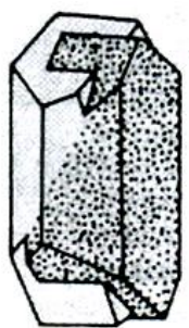
Macle de Carlsbad de la Sanidine (feldspath potassique)
