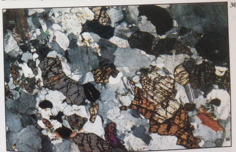
30 Orthopyroxène (grossissement \times 15 , LPA).
