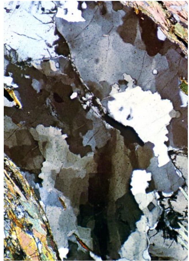
Quartz : Extinction roulante et cristaux xénomorphes
