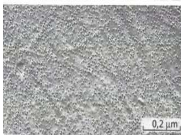
Membrane vue de face après cryofracture avec ombrage (Peyru, 2013)
