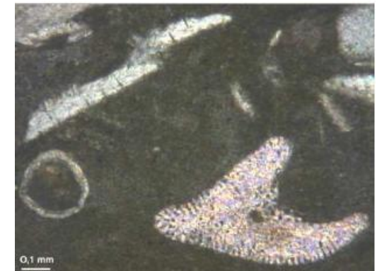
Micrite en LPA avec >10% éléments figurés Wackestone
