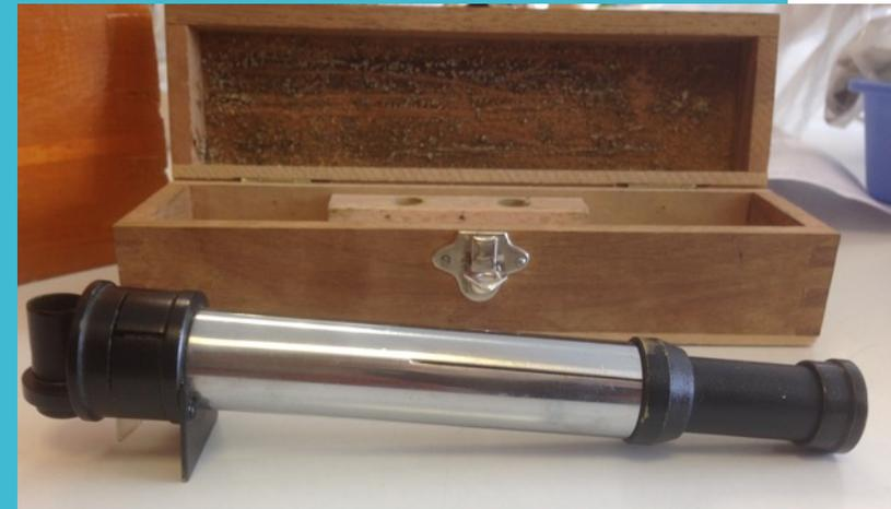
Les spectromètre permet d'observer la lumière passant ou non à travers une solution. Avec un solvant translucide, on observe toutes les radiations de la lumière visible. Avec une solution de pigments extraits dans ce même solvant, les radiations absorbées ne sont plus visibles.
