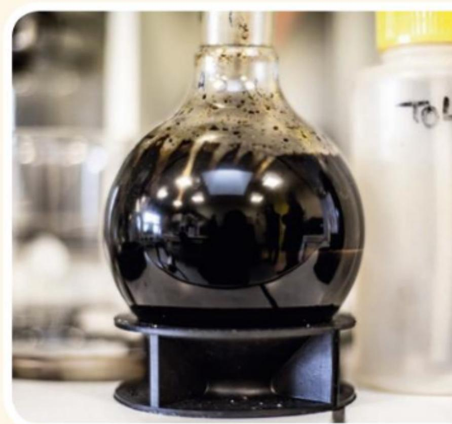
**Bio-bitume obtenu à partir des micro-algues.** Le procédé utilisé, dit de liquéfaction hydrothermale, utilise de l'eau sous pression.
